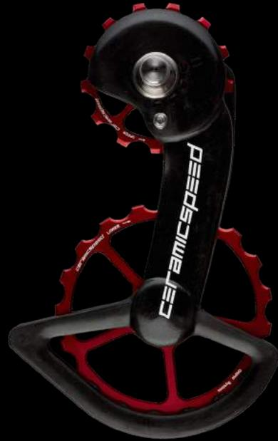
**Sobredimensiona tu rodada.** Comprométete con la velocidad gratuita ahorrando watts con el Sistema Sobredimensionado de Poleas OSPW de CeramicSpeed, el cual incrementa la eficiencia en el tren de transmisión, al eliminar la forzada articulación de la cadena encontrada en los sistemas de ruedas de poleas estándares de 11 dientes.
