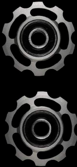
**La menor fricción posible.** Las ruedas de poleas en el desviador trasero, son los componentes con la rotación más rápida en la bicicleta. En la RPM más alta en una bicicleta de ruta, las ruedas de poleas giran de 4 a 5 veces más rápido que el bottom bracket (dependiendo del radio de velocidad y la velocidad del ciclista). Esto significa que las ruedas de poleas que generan baja fricción son extremadamente deseadas.
